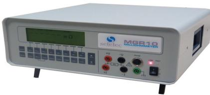
A francia gyártó komoly szakmai elismerést szerzett a gyártósori vizsgáló berendezéseivel. Az MGR10 egy sokoldalú, nagypontosságú ellenállásmérő műszer, mely felhasználási igény szerint 4 változatban rendelhető: standard, akkus-, kontakt-ellenállásmérő és pirotechnikai modell. A mérés 4-vezetékes és lehet hőmérőkkel kompenzált, a pontosság jobb, mint ±0,03%, a mérőáram max. 10 A. Méréstartománya 0,1 μΩ ÷ 30 kΩ, mely manuálisan/automatikusan váltatható. 4000 mérés tárolására alkalmas
